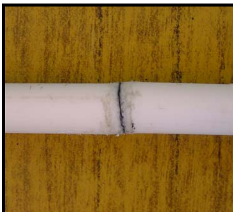
Figura 14. Piezas de un termoplástico (polietileno) soldadas por acción de las microondas sobre una junta de polianilina.
