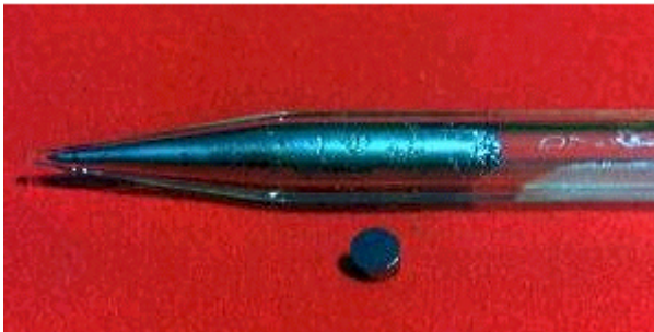
Crecimiento monocristalino de \text{Hg}_{1-x}\text{Cd}_x\text{Te} ( x = 0.2 )
