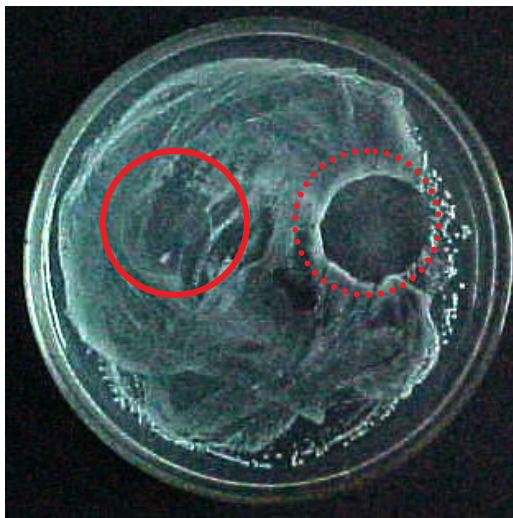
Figura 11. A la izquierda de la figura, PP sin modificar (línea continua); a la derecha, PP modificado con ácido acrílico (12,9% de injerto) conteniendo natamicina (línea discontinua), en el cual se evidencia una clara zona de inhibición en el crecimiento de levaduras por debajo del mismo.
