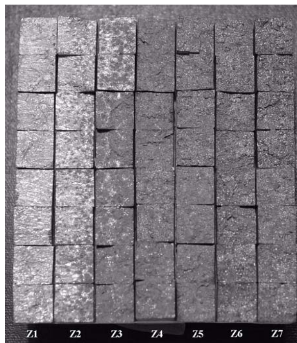
Figura 8. Aspecto de las superficies de fractura, mostrando un mapa de comportamiento para diferentes distancias al enfriador.
