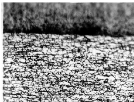
Figura N° 2. Sustratos metálicos de la chapa ECCS microestructura del acero de bajo carbono y recubrimiento de cromo electrolítico, x100 MO.
