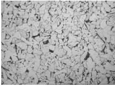
Figura 3. Microestrutura característica do bloco da faixa de 60-80 HRB. Material A, normalizado. Presença de ferrita e colônias de perlita. 130 X.
