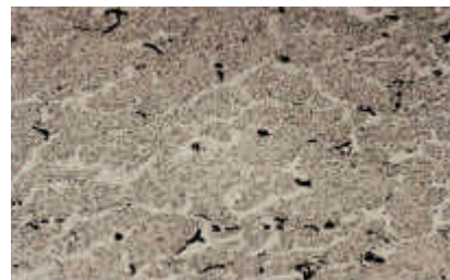
Figura 2. Microestrutura do bloco da faixa de 20-50 HRB. Material E, como recebido. 200X.
