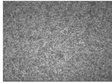
Figura 7. Microestrutura do bloco da faixa de 60-70 HRC. Material D, temperado e revenido. Predominância de martensita revenida. 310X.
